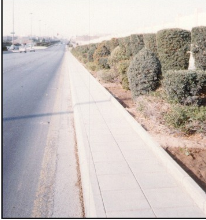
شكل رقم ( 1 ) يوضح الطريقة الصحيحة لزراعة الأرصفة وذلك بزراعة النباتات على جانب الرصيف وترك مساحة عريضة من الرصيف لمرور المشاة
